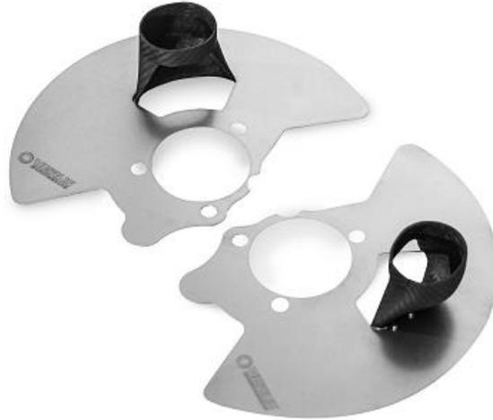
**2. Brake Cooling Kit Install**
